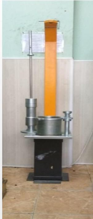
Уплотнение осуществляется при 50 ударах груза с двух сторон. Диаметр образцов составляет 100 мм, а высота 63 мм. Для смесей с номинальным максимальным размером зерен минерального заполнителя 31,5 мм изготовление асфальтобетонных образцов диаметром 150 мм.
